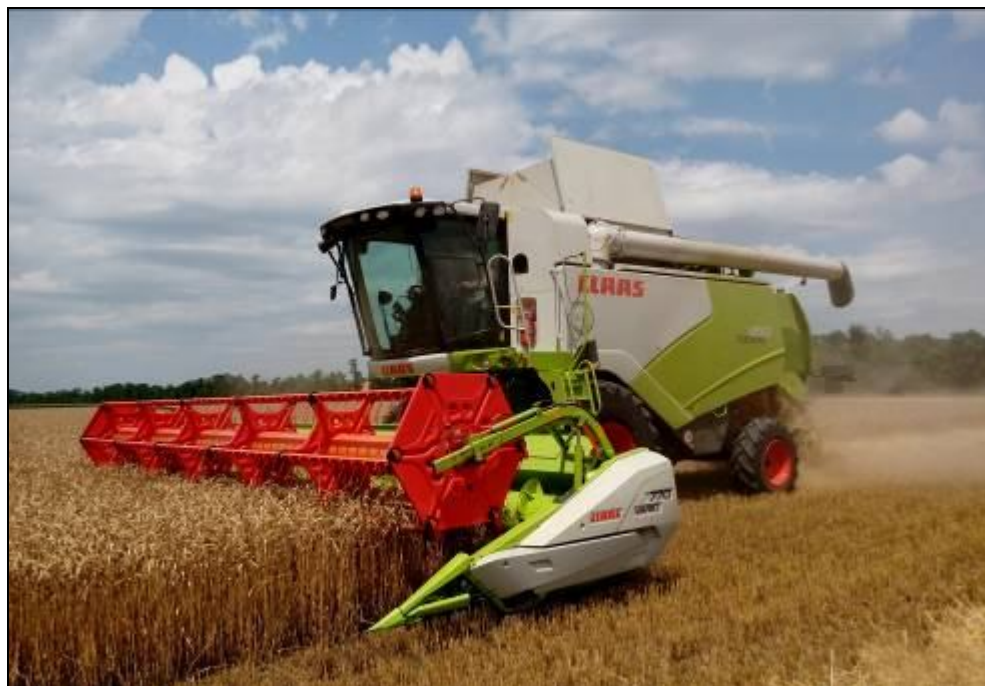
Рисунок 2 – Комбайн зерноуборочный Тисано 450 с жаткой зерновой VARIO 770 на прямом комбайнировании озимой пшеницы
